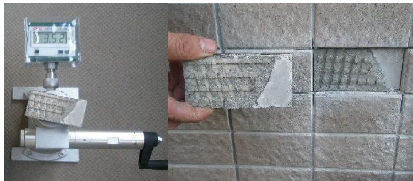
(試験体破壊時の最大引張荷重の計測と破壊面の観察)
