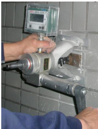
(引張接着強度試験状況)
